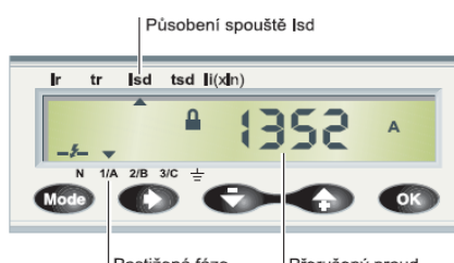
Zobrazení přerušeného proudu při poruše.
