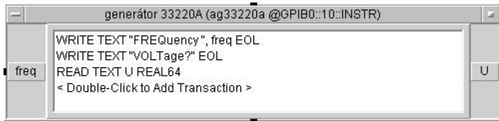
obr 4. Nastavení ovladače generátoru Agilent 33220A pomocí SCPI příkazů.
