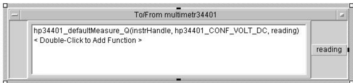
obr 5. Příklad nastavení Plug&Play ovladače multimetru Agilent 34401
