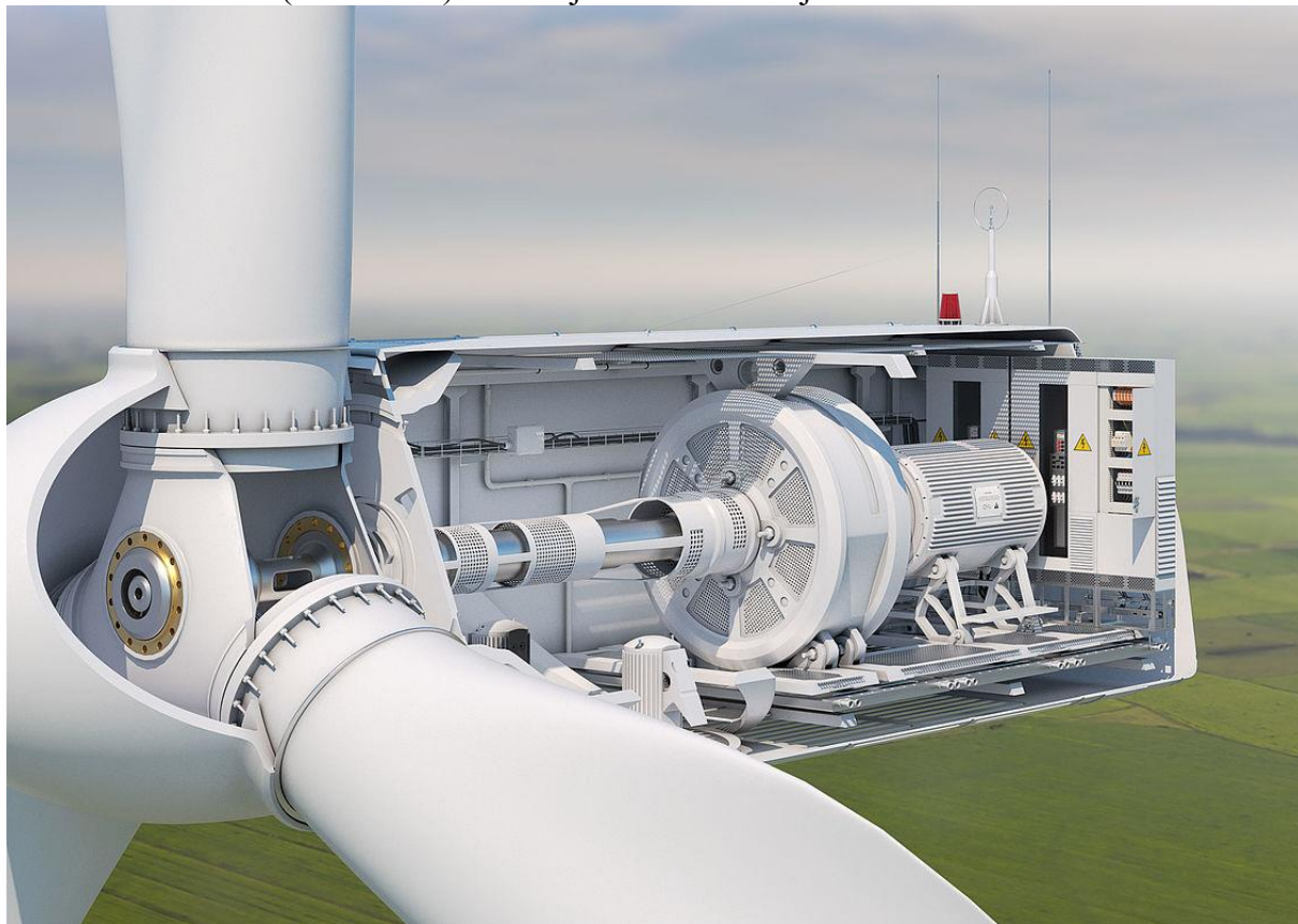
Obr.90. Řez gondolou větrné elektrárny
